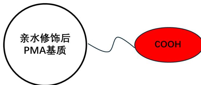
图 1.层析介质配基结构示意图
